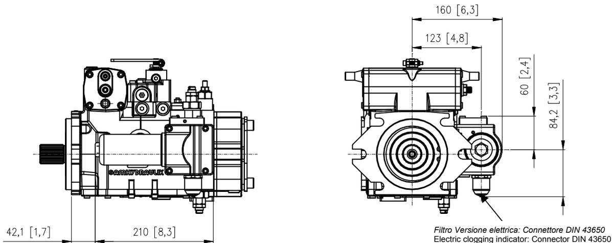
**Pompa SH6V 75 - Flangia SAE C 2÷4 Fori - Filtro+ Taglio elettrico (TE)**
