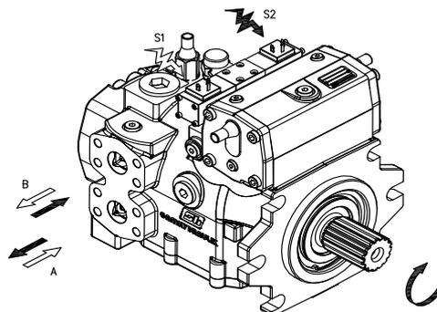
Alimentando uno dei due elettromagneti ON-OFF (standard 24V c.c. opzionale 12V c.c.), la pompa si porta alla cilindrata massima nel senso di mandata corrispondente al magnete eccitato. Togliendo l'alimentazione la pompa si porta in annullamento di portata.
