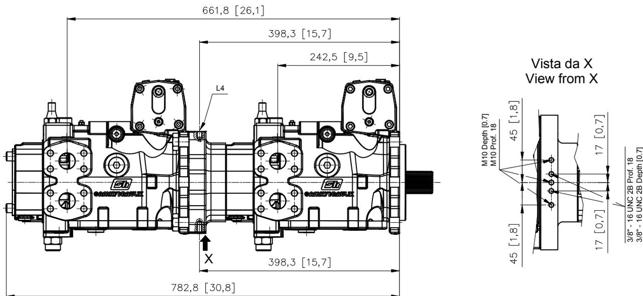
L4: Attacco drenaggio flangia di accoppiamento / Drain port couple flange - 1/4 G (BSPP) Prof./Depth 13 [0,5]
