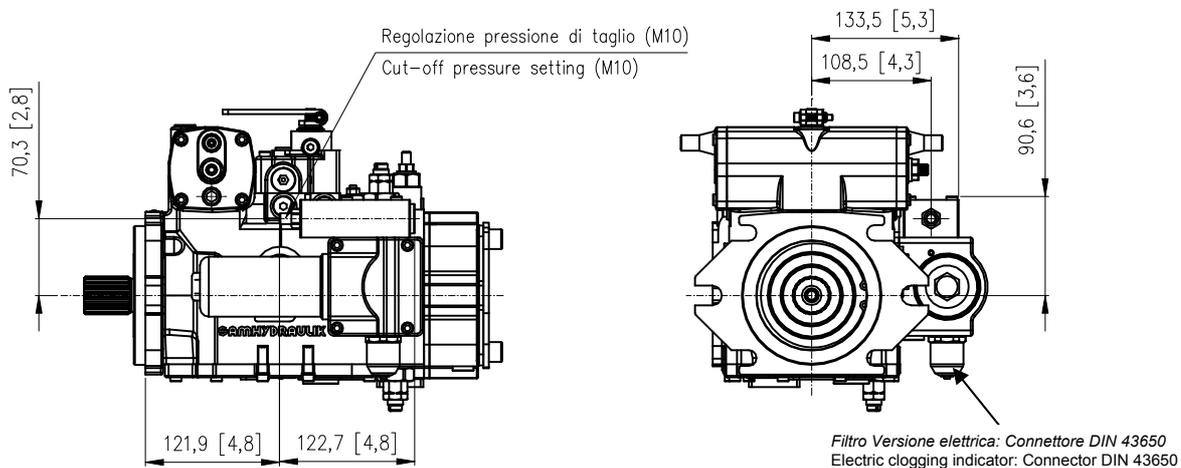
**Pompa SH6V 75 - Flangia SAE C 2÷4 Fori - Filtro+ Taglio elettrico - Taglio pressione (EP)**
