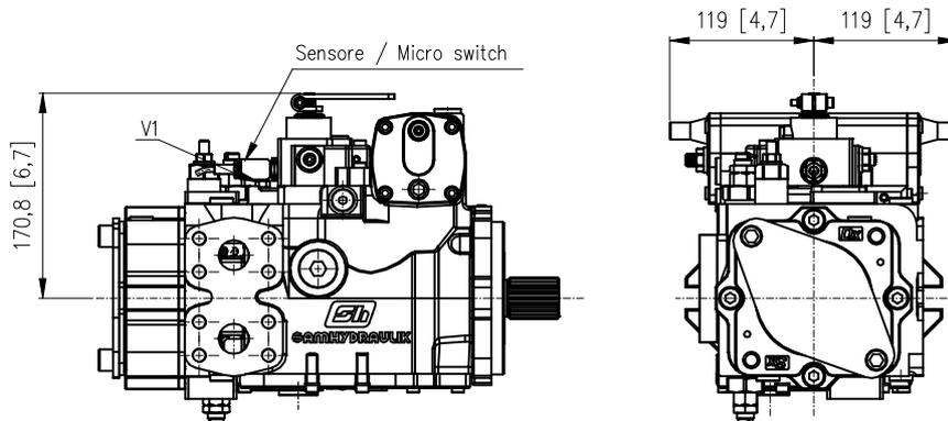
V1: Strozzatore variabile / Adjustable throttle valve
