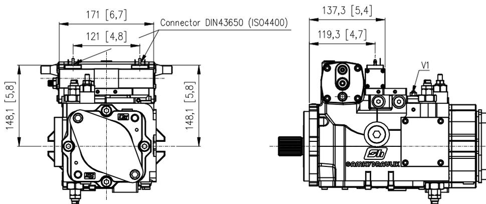
V1: Strozzatore variabile / Adjustable throttle valve
