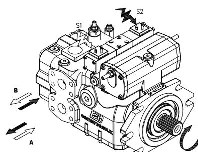
Alimentando uno dei due elettromagneti ON-OFF (standard 24V c.c. opzionale 12V c.c.), la pompa si porta alla cilindrata massima nel senso di mandata corrispondente al magnete eccitato. Togliendo l'alimentazione la pompa si porta in annullamento di portata.
