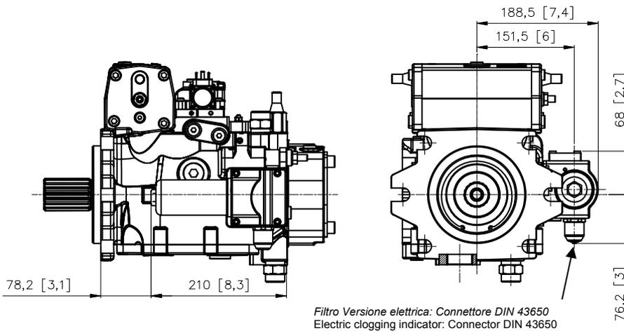
**Pompa SH6V 130 - Flangia SAE D 2÷4 Fori - Filtro+ Taglio elettrico (EP)**
