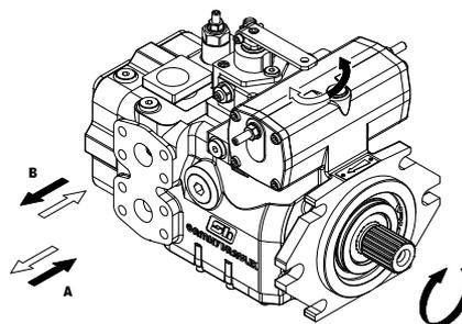
La pompa assume una cilindrata direttamente proporzionale all'angolo impostato dalla leva. La retroazione sente l'eventuale errore di posizionamento del piatto oscillante e tende a correggerlo automaticamente tramite il servocomando. Il sensore di posizione è costruito con logica PNP, di conseguenza il sensore si trova in stato di  $T_{bassa}$  quando la leva è in posizione neutra. Qualsiasi movimento della leva porta il sensore in stato di  $T_{alta}$ .
