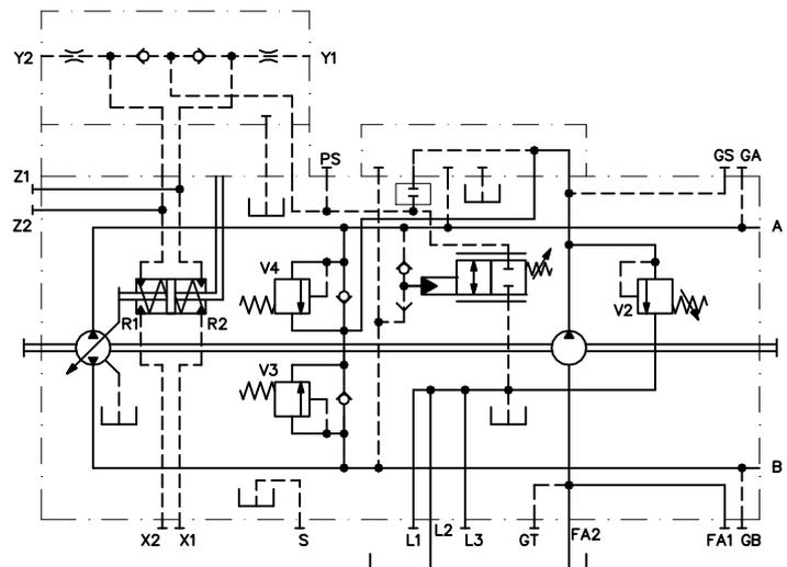
**Senso di rotazione:** Correlazione tra il senso di rotazione della pompa (visto dal lato albero) e l'azionamento del regolatore.
