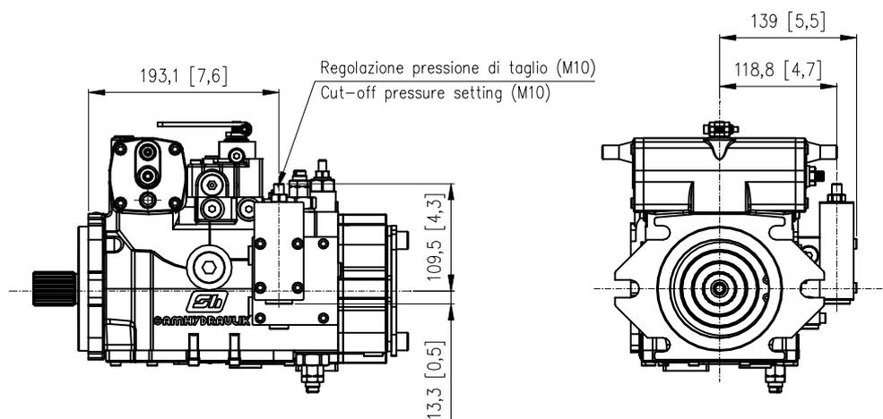
**Pompa SH6V 75 - Flangia SAE C 2÷4 Fori - Taglio elettrico - Taglio pressione (EP)**
