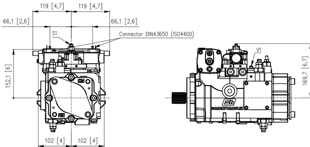
S1-V1: Strozzatore variabile / Adjustable throttle valve
