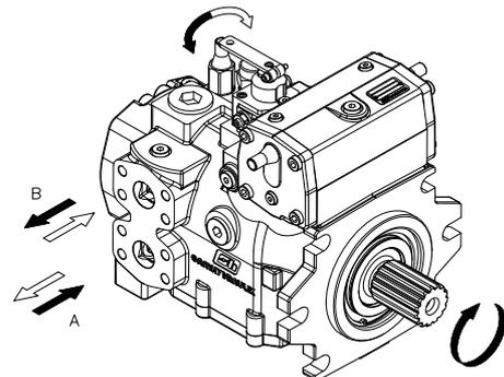
La pompa assume una cilindrata direttamente proporzionale all'angolo impostato dalla leva. La retroazione sente l'eventuale errore di posizionamento del piatto oscillante e tende a correggerlo automaticamente tramite il servocomando. Il sensore di posizione è costruito con logica PNP, di conseguenza il sensore si trova in stato di  $T_{bassa}$  quando la leva è in posizione neutra. Qualsiasi movimento della leva porta il sensore in stato di  $T_{alta}$ .
