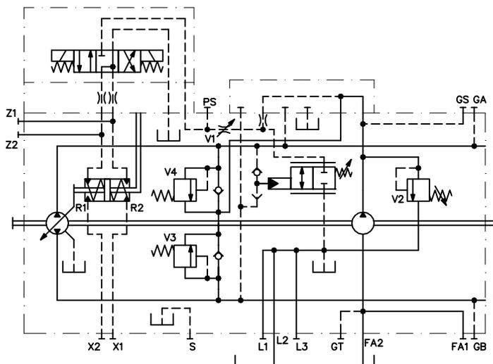
**Senso di rotazione:** Correlazione tra il senso di rotazione della pompa (visto dal lato albero) e l'azionamento del regolatore.
